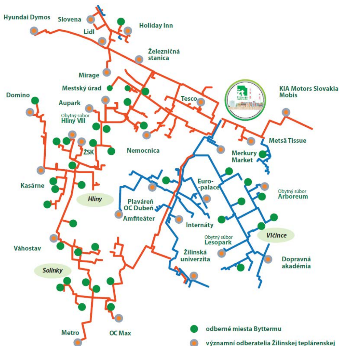
Obr. 14 Primárne parné a horúcovodné tepelné siete SCZT, Ť. T., a.s., Ťilina (Zdroj: Ť. T. a.s.)
